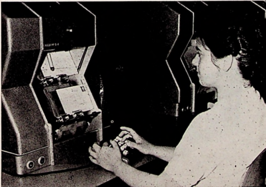
20.000 brieven per uur in 100 richtingen kunnen met deze Telefunken machine gesorteerd worden. Door de Duitse P.T.T. wordt tegenwoordig deze machine met succes toegepast.
