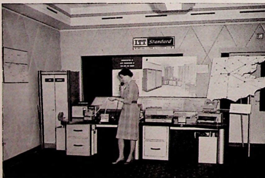
Gegevens overbrenging (data transmissie) met fouten-detectie en -correctie (I.T.T. Standard)
